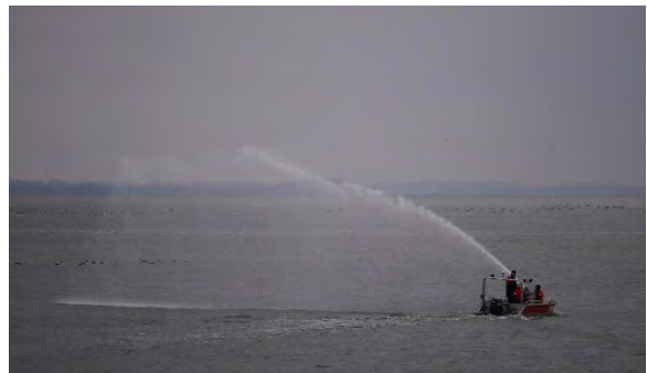
Abbildung 22 Mit entsprechender Abstimmung zwischen Boots- und Strahlrohrführer sowie dem Maschinisten der Tragkraftspritze konnte Wasser gezielt über einen längeren Zeitraum abgegeben werden.
