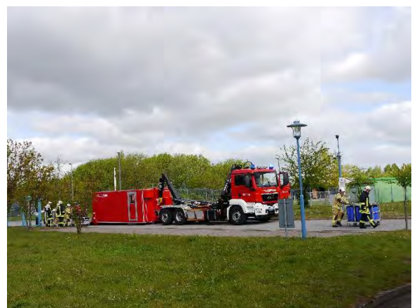
Abbildung 37 Auf dem Abrollbehälter Logistik sind 720 Liter Schaummittel-Konzentrat verlastet, die hier zum Einsatz gebracht werden.
