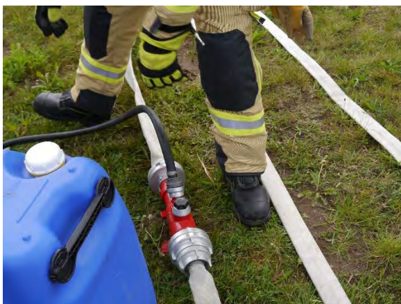
Abbildung 40 Die Beimischung des Schaummittelkonzentrats erfolgte über übliche Z-4-Zumischer – hier wurde statt Schaummittelkonzentrat Wasser verwendet.
