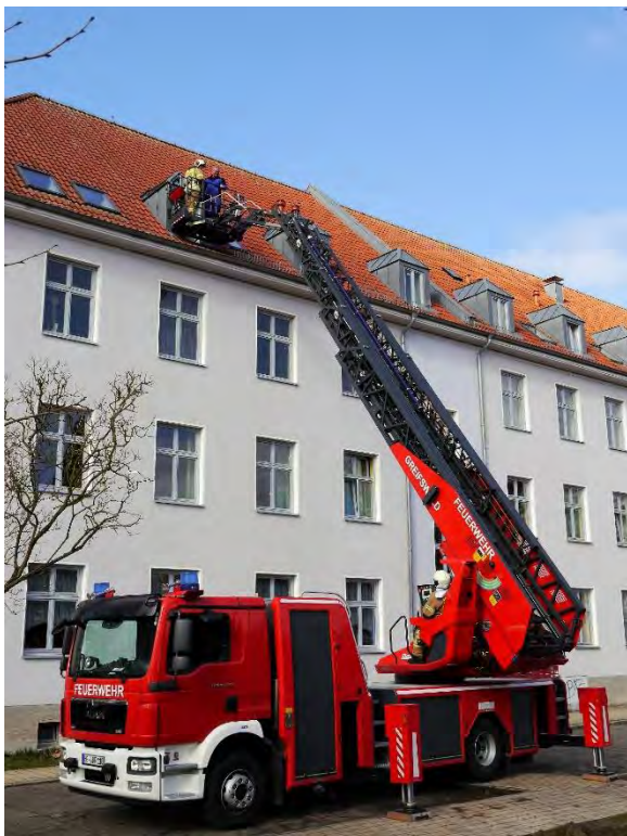
Abbildung 19 Am Rande der Übung wurde die Anleiterbarkeit des Gebäudes überprüft. Hier sieht man die Vorteile, die eine Drehleiter mit Knick-Arm bietet.
